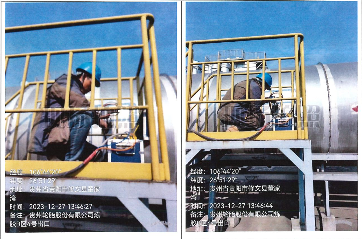
有组织废气现场监测图片
