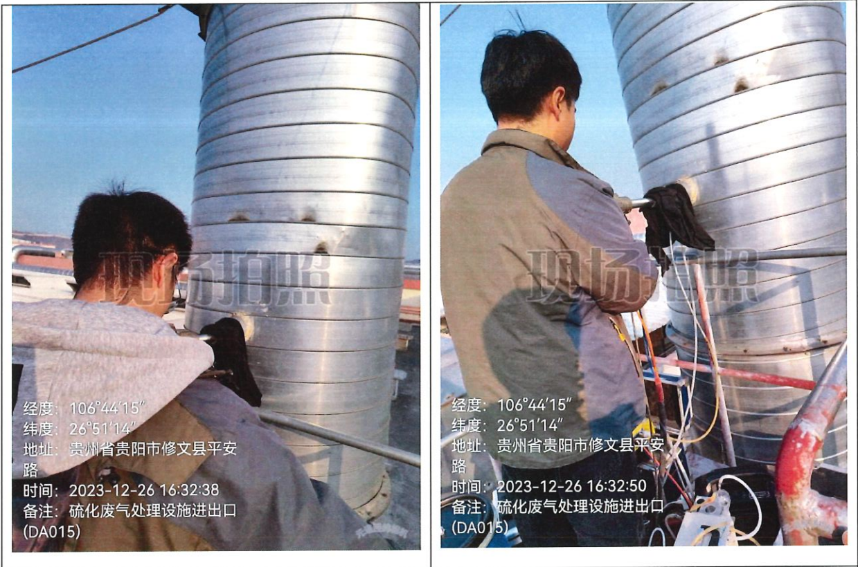
有组织废气现场监测图片
