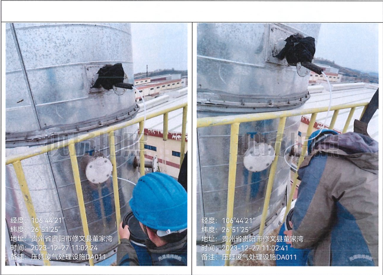
有组织废气现场监测图片
