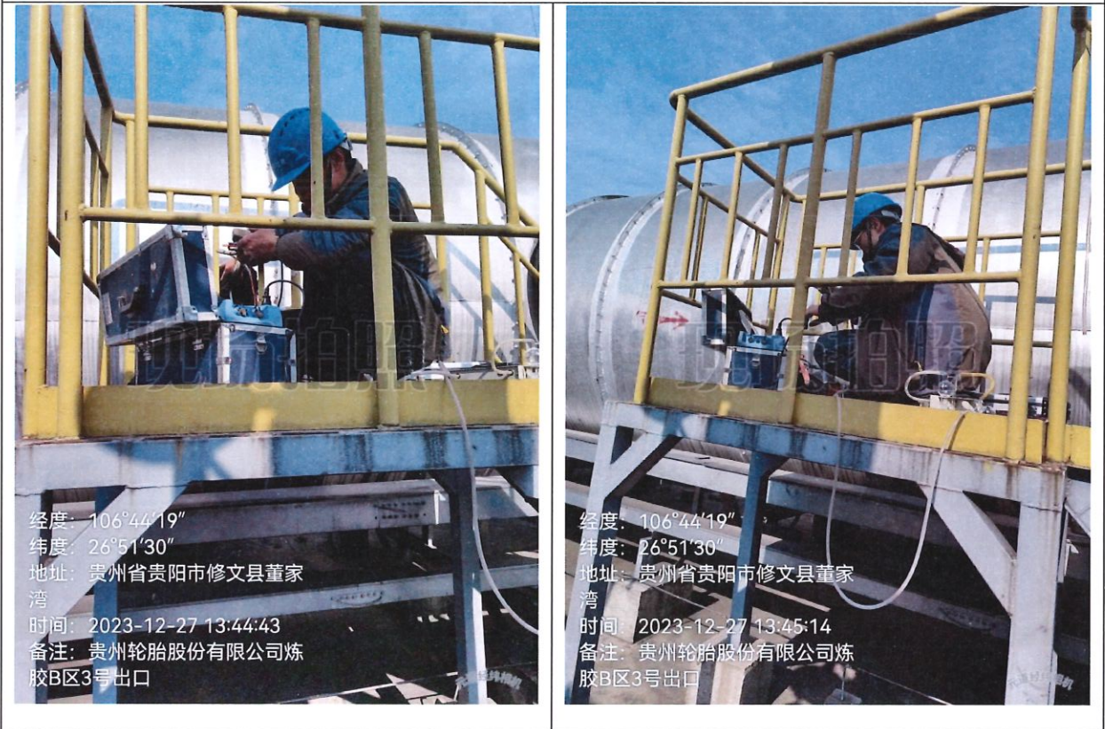
有组织废气现场监测图片
