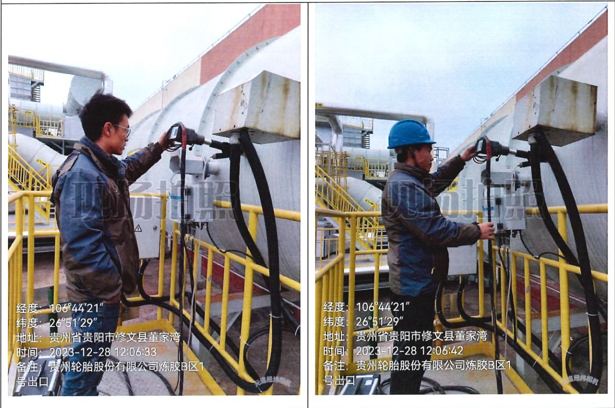
有组织废气现场监测图片
